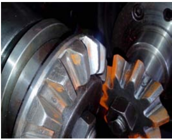
图 9 V=0\text{ mm} , H=-1\text{ mm} 时的滚检印痕 Fig. 9 Rolling pattern for V=0\text{ mm} , H=-1\text{ mm}
