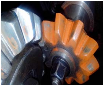
图 11 V=-1\text{ mm} , H=0\text{ mm} 时的滚检印痕 Fig. 11 Rolling pattern for V=-1\text{ mm} , H=0\text{ mm}
