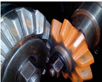
图 8 V=0\text{ mm} , H=0\text{ mm} 时的滚检印痕 Fig. 8 Rolling pattern for V=0\text{ mm} , H=0\text{ mm}
