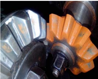
图 12 V=1\text{ mm} , H=0\text{ mm} 时的滚检印痕 Fig. 12 Rolling pattern for V=1\text{ mm} , H=0\text{ mm}
